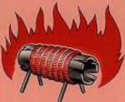
Самодельный пробочный предохранитель ("жулик")
